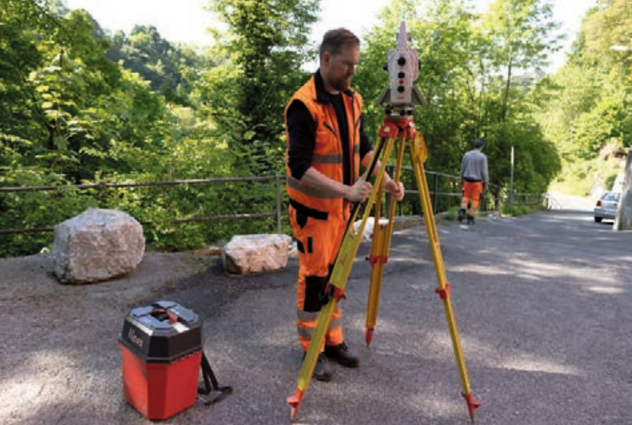
◀ Alain-Pierre Meyer installe sa station totale afin de mesurer des points de contrôle permettant de vérifier si le terrain est resté stable.
